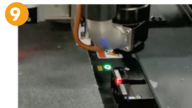
Sistema de inicialização Automático Inicialização automática através de sensor de deslocamento que identifica a origem e a profundidade do corte.
